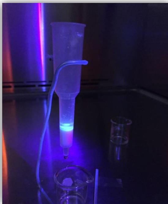
**Figura 6** En la purificación de la proteína GFP se observó el anillo de proteína GFP adherido a la resina que contiene la columna de interacción hidrofóbica, mediante un buffer de lavado dicho anillo descendió por las paredes de la columna de cromatografía.
